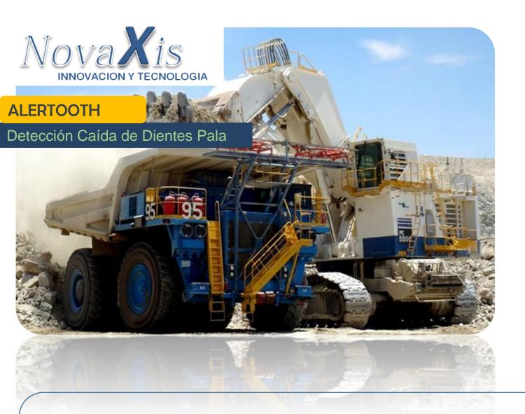
ALERTOOTH es un sistema de detección y localización de dientes de pala que consta de un sensor "VelaPulsar" desarrollado en Canadá, e integrado en Chile por Novaxis. El "Vela Pulsar" se introduce en el diente y puede emitir una señal RF hasta por 1 mes, siendo detectada por lectores RF instalados en todos los equipos mineros. Los camiones, palas y equipos de apoyo se convierten en scaners que rastrean y encuentran dientes caídos en el suelo o en una tolva, evitando llegar al chancador
